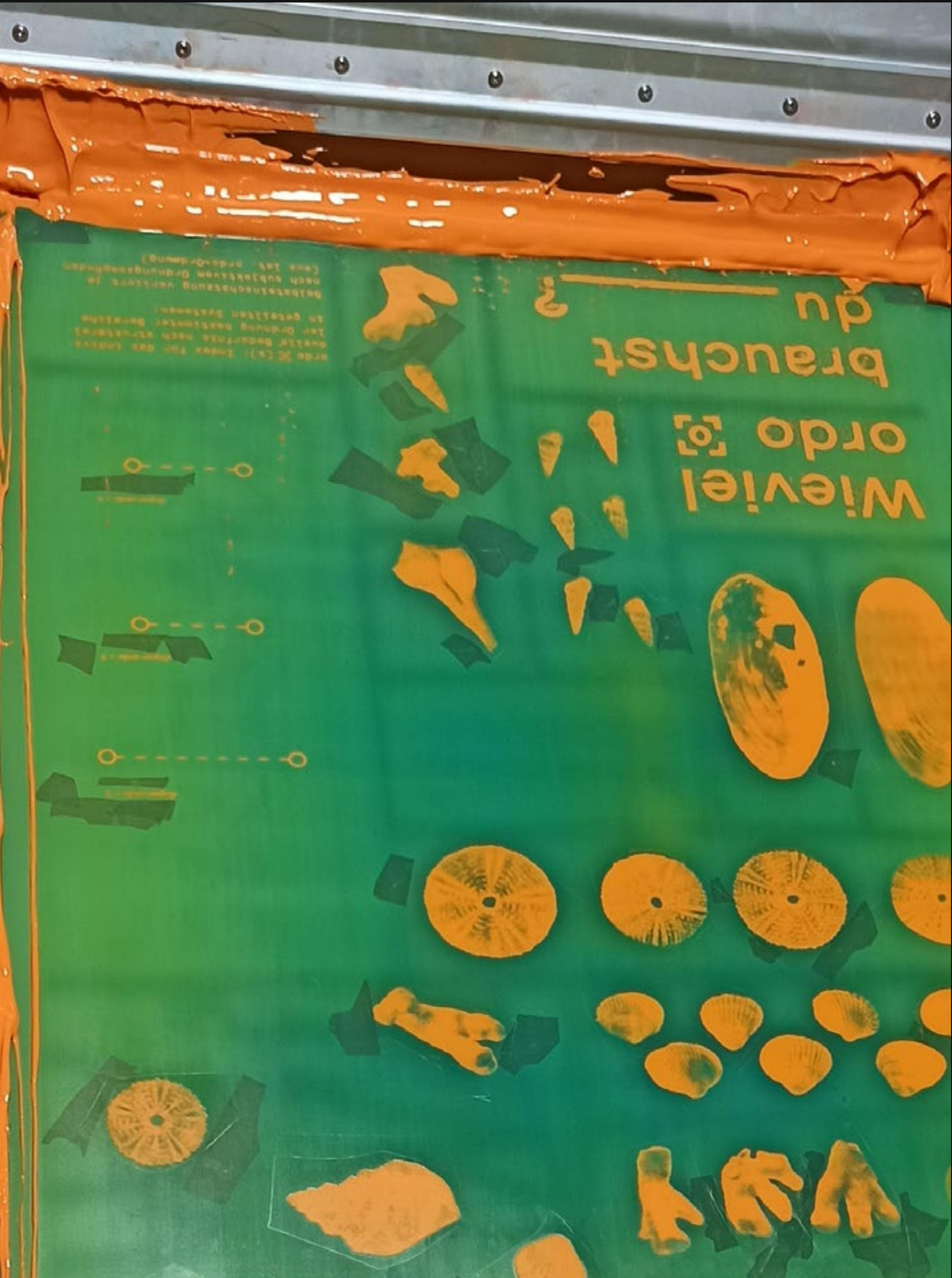
Mit einem Rakel wird Farbe durch ein Sieb gepresst.
