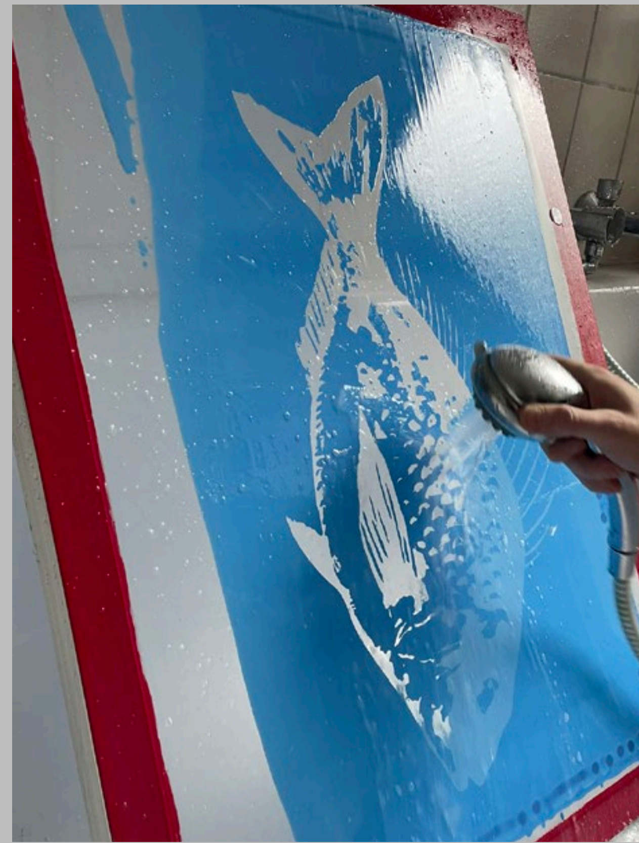
Ein Sieb wird nach dem Belichten ausgewaschen
